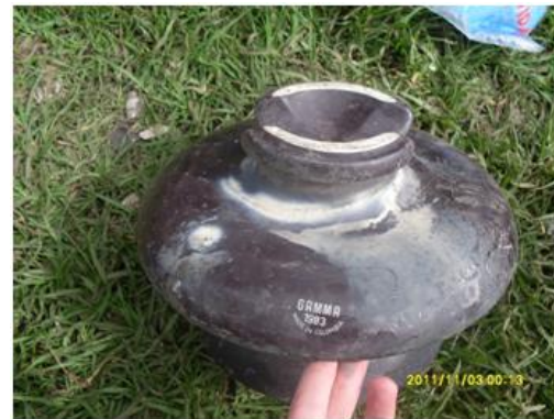
Fotografía 1. Aislador con efecto corona
