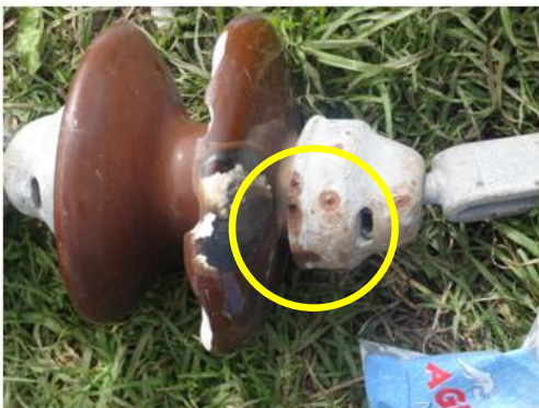
Fotografía 4. Aislador con Descarga tipo arco
